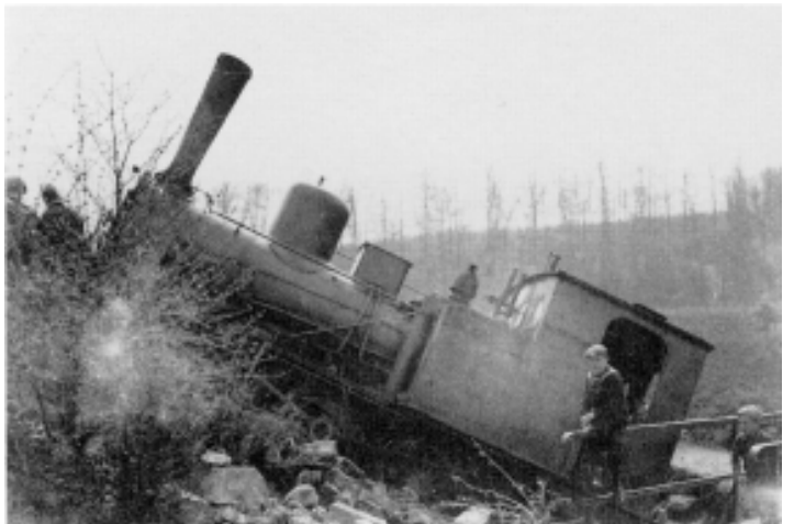
Am 30. Mai 1931 verunglückte diese Lock nach Überfahren eines Prellbocks und landete in der Böschung.
