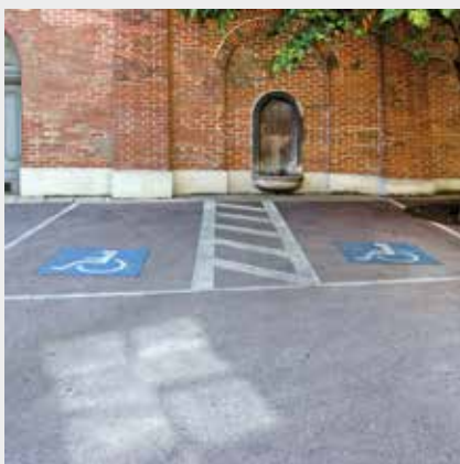
Durch die markierte Bewegungsfläche zwischen den Stellplätzen sind beide Stellplätze barrierefrei nutzbar
