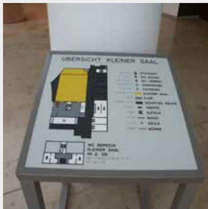
Der taktile Orientierungsplan verschafft nicht nur blinden Menschen und Menschen mit Sehbehinderungen einen Überblick
