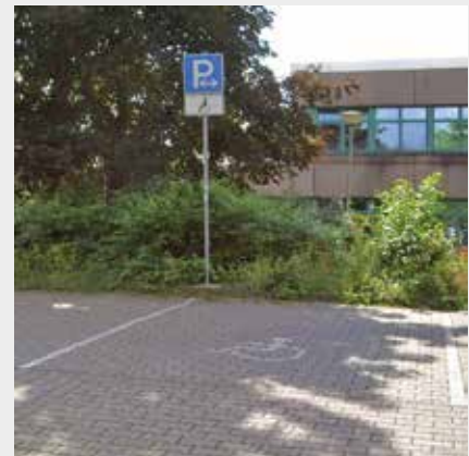
Bei diesem Stellplatz ist der gefahrlose Ausstieg beidseitig möglich
