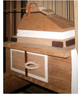
Rekonstruierter Kanaltremulant in Bauweise des 17. Jahrhunderts
